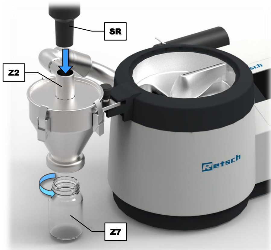
Abb. 30: Anschließen des Industriestaubsaugers am montierten Zyklonabscheider
